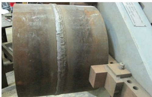
SMA Weld (E9015-B91)
